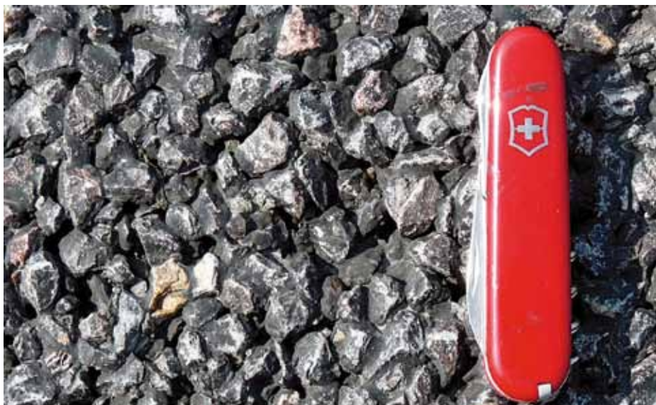
Figur 2. Close up foto af den to år gamle drænasfalt.
