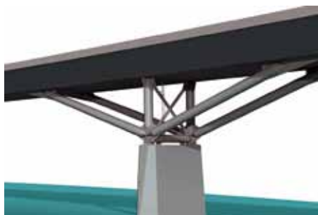
Figur 9. V-formede understøtninger af brodrager.
