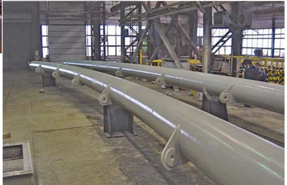
Figur 7. De to færdige buesektioner er klar til afrejse til Danmark. Øjerne til trækstag har alle lidt forskellig vinkel til buen. Foto Bladt.
