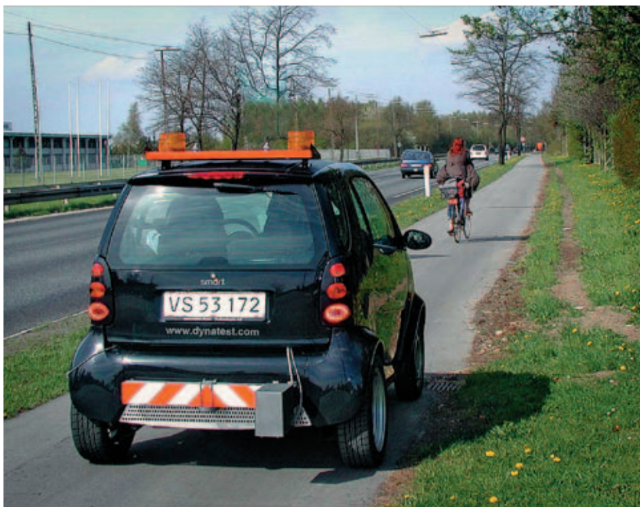
Figur 1. Samtlige målinger er udført med den viste SMART bil. Laseren er ca. 0,5 m. fra stikanten.
