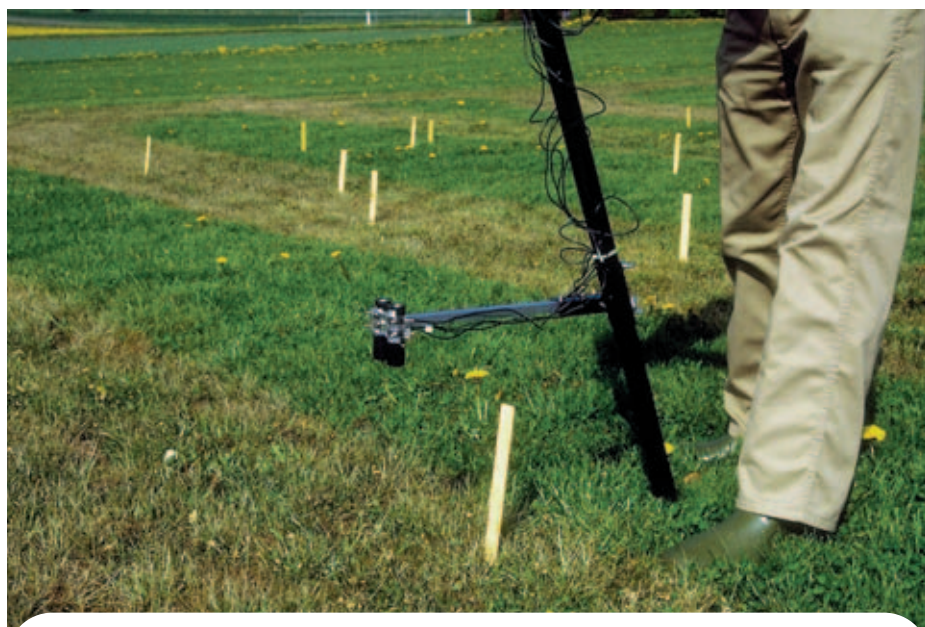
Figur 2. Behandlingernes effektivitet er målt med reflektansmåler, der måler 'mængden' af grønt i en 40 cm cirkel. Billedet viser måling i en parcel behandlet med 103 kg gas/ha (1318 kWh/ha) én dag efter behandling.
