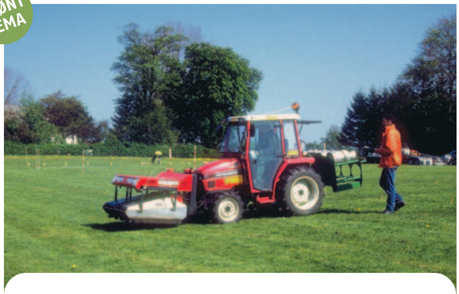
Figur 1. HOAF WeedStar 50*50 frontmonteret med flaskebatteri bag på traktoren. Brænderkasserne kan sideforskydes og behandle begge kanter på sti.
