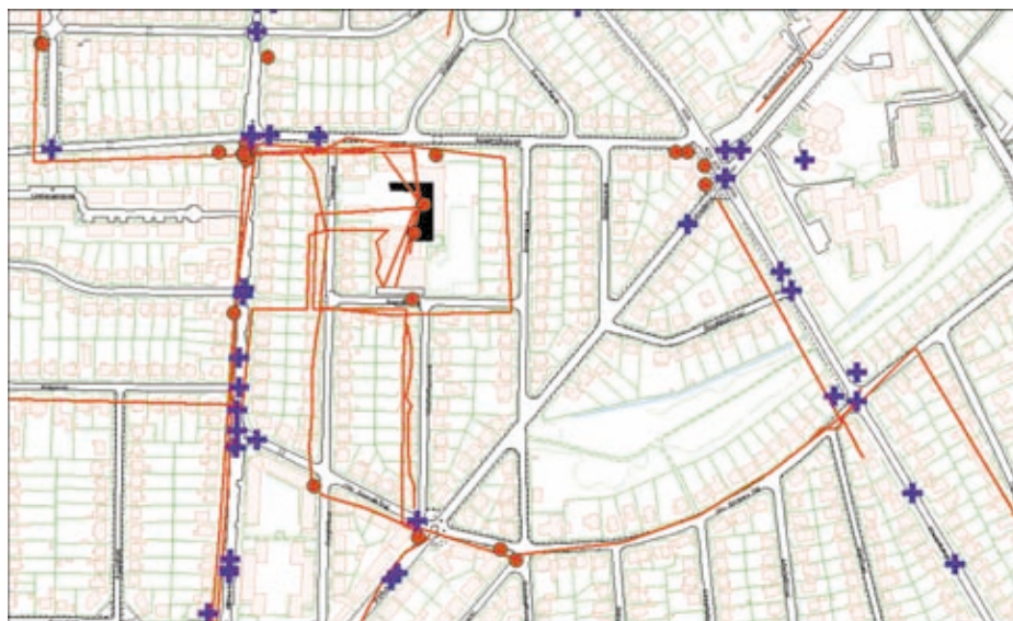
Figur 6. Utrygge kryds (pletter) og strækninger (streger) er kombineret med trafikulykker (kryds) i GIS.
