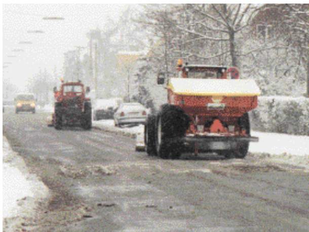
Fig. 3. Saltning under snerydning. Med en saltspreder monteret på den ene traktor i en snerydningskolonne kan saltet udnyttes optimalt, fordi det udspredes straks efter snerydningen.
