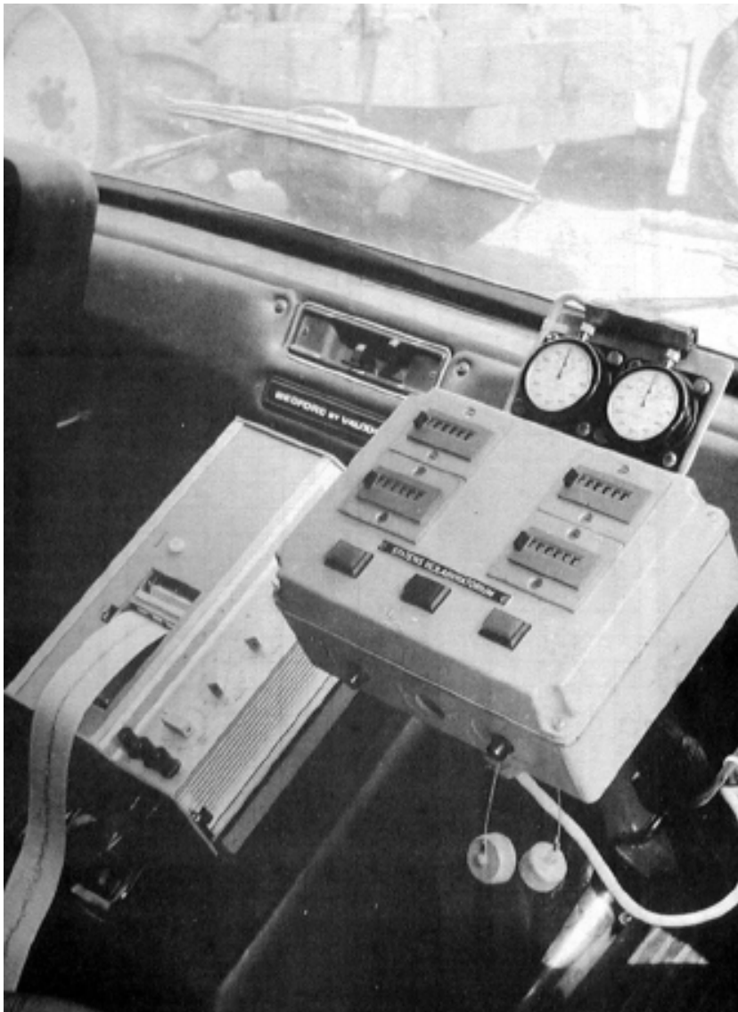
Registreringsudstyret i bumpmeteret med Zilog Z 80, der gør det enkeltmandsbetjent.
