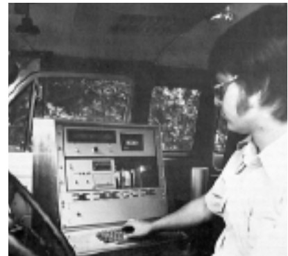
Registreringsudstyret i bumpmeteret med Zilog Z 80, der gør det enkeltmandsbetjent.
