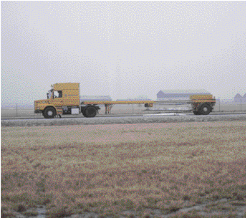
Den nye deflektograf i målesituation. Målebroen er netop sat ned klar til at gennemføre en måling, hvor føleren passerer af tvillinghjulene. Vægte på disse er placeret over hjulene og kan varieres.
