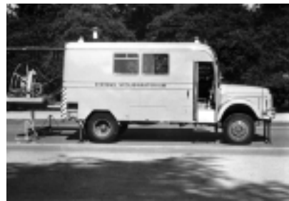
"Vikingen" med udslået målearrangement. Aflæsningen af nedsynkningen sker med tre måleure i pladekanten.
